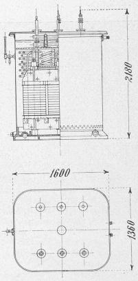
Fig. 5. - Transformateur de 850 kva.
