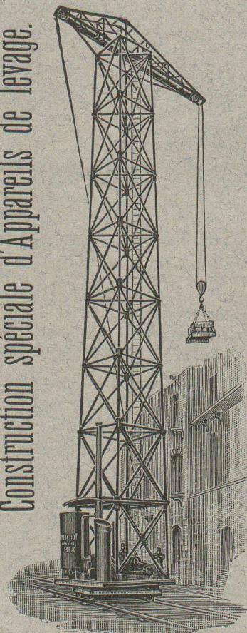
Grandes GRUES à VAPEUR roulantes et pivotantes, circulant sur toutes les faces d'une construction ; supprimant tout échafaudage ; économisant le 70 % de main d'œuvre des manœuvres ; pouvant éléver 120 tonnes de matériaux par jour à 20 mètres de hauteur, pour charge de 3 à 6000 kg.
