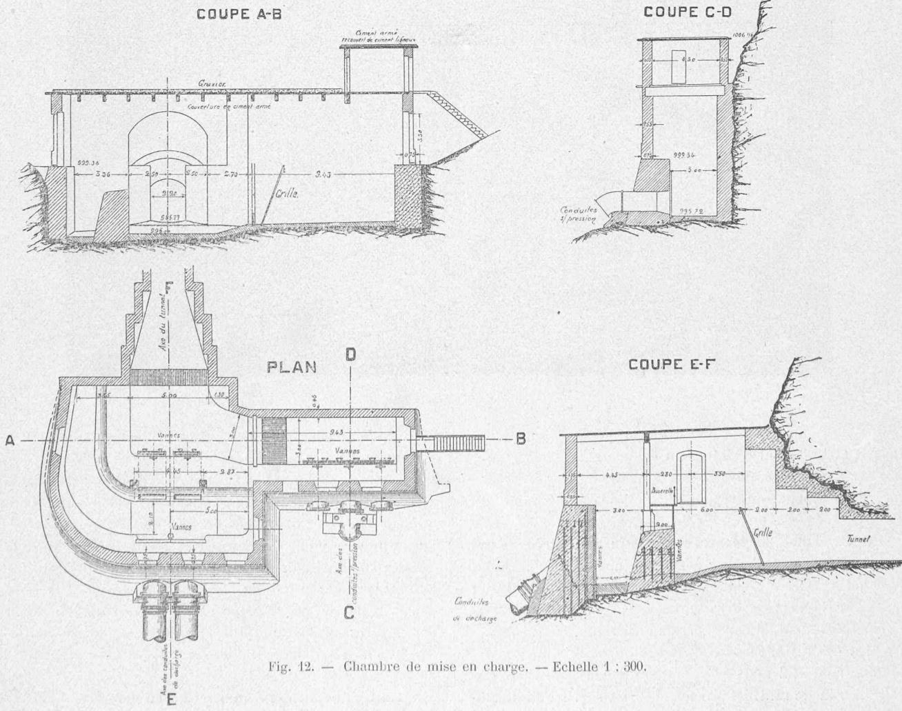
Fig. 12. — Chambre de mise en charge. — Echelle 1 : 300.
