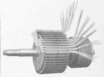
Détail de l'enroulement induit.
