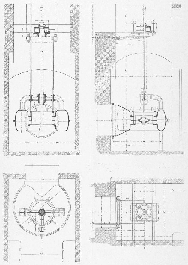
Fig. 5. — Turbines de l'usine centrale de Papigno.
