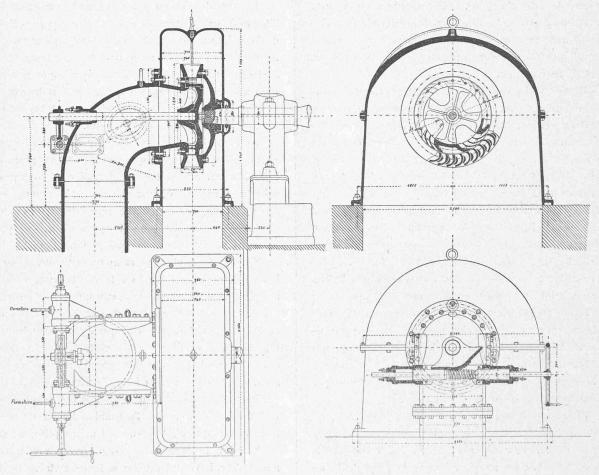
Fig. 1. — Turbines de l'usine de Collestate.
