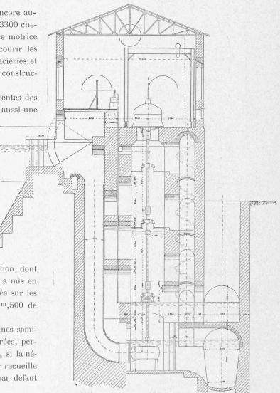
Fig. 4. — Usine centrale de Papigno. — Coupe transversale. Echelle: 1: 200.
