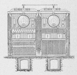
Fig. 36. — Chaudière Guilleaume. — Face arrière.
