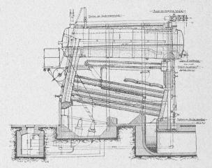
Fig. 37. — Chaudière Guilleaume. — Coupe longitudinale. Echelle: 1:133.
