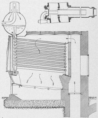
Fig. 38. — Chaudière Niclausse. — Coupe longitudinale.
