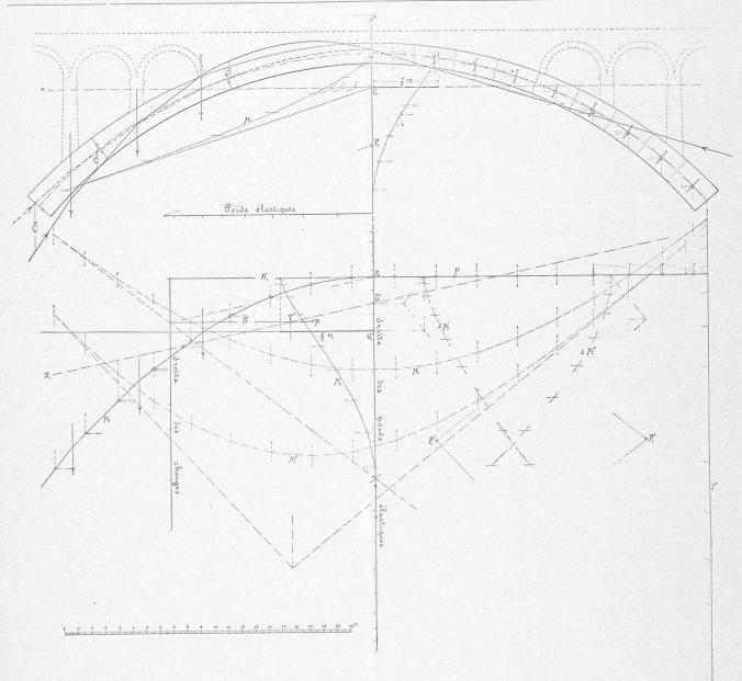
$\label{eq:Fig.24.} Fig.~24. \ -\ Pont~Antoinette. \ -\ Ligne~Montauban-Castre$  Courbes de pressions. -- Charge uniforme sur l'arc entier ou une moitié.
