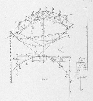
On commence par tracer l'axe x'. La verticale par G est déterminée par le polygone funiculaire  $p_0$ , des poids élastiques verticaux w. Son pôle est  $P_0$ , arbitrairement choisi. Les segments déterminés sur la verticale y', arbitraire, par les côtés de  $p_0$  sont proportionnels aux moments statiques des poids correspondants, par rapport à y'.
