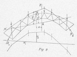
Soit  $\eta$  l'ordonnée verticale du pôle d'une barre quelconque au côté correspondant, prolongé s'il le faut, du polygone des pressions. Soit  $\eta'$  l'ordonnée verticale correspondante (fig. 9) de ce côté à l'axe des x', nous avons alors
