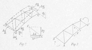
d'un nœud, c'est-à-dire la projection orthogonale de son déplacement réel sur la verticale. Le déplacement suivant x' sera  $\Delta d \cos \varepsilon$ , où  $\Delta d$  représente, sur l'horizontale, la projection, orthogonale à x', du déplacement réel du point.
