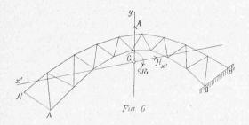
7. — Equations d'élasticité. Si nous appliquons les valeurs 9) à l'extrémité BB' de l'arc (fig. 6), nous obtenons les trois équations, dites d'élasticité:
