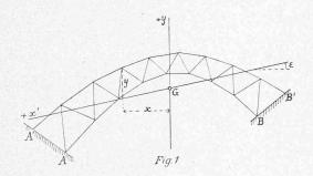
La construction est soumise à des forces situées dans son plan et centrées aux nœuds. Supposons une variation de température de  $t^{\circ}$  et un tassement des culées, ou, ce qui revient au même, que l'arc, par défaut de construction, ne remplisse pas exactement sa place, et que, monté sur une culée, il faille le déformer pour le fixer à l'autre.
