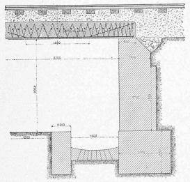
Fig. 14. — Coupe en long.Passages inférieurs d'Aigle et d'Yvorne.
