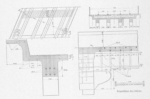
Fig. 6. — Passage inférieur du Creux-Dumas, près Rolle. — Plan, coupe en travers et détails.
