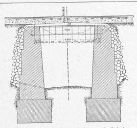
Fig. 7. — Passage inférieur de la gare de St-lmier. Coupe en long.
