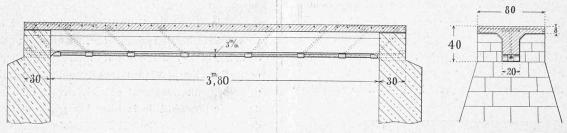
Fig. 3. — Poutre en béton armé système Lossier (Nº 2). Armature : 1 barre ronde de 30 mm. — Echelle : 1 ; 40.
