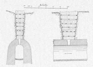
Fig. 4. - Détails du puits de dégagement de l'aqueduc.
