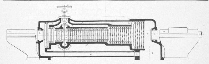
Fig. 9. — Coupe en long schématique par l'axe d'une turbine Parsons.
