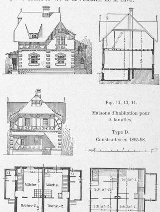
Les murs sont en maçonnerie, jointoyés ou crépis à l'extérieur.
