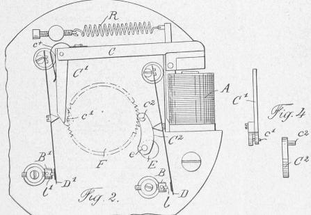
Dès que l'amplitude des oscillations du balancier est descendue au-dessous d'une valeur déterminée, cet électro-aimant entrant en jeu attire l'armature en communiquant au système une impulsion nouvelle. Cette prise de courant au moment voulu s'obtient par différents procédés.
