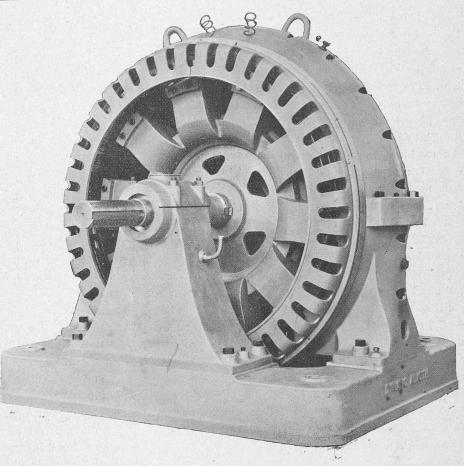
Fig. 21. — Alternateur de 265 kilowatts à 3000 volts.
