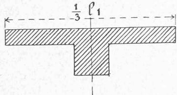
Vo<sup>r</sup> Pour le calcul au flambage des colonnes on adoptera la formule :  $J = 60 P l^2$  où  $J$  est le moment d'inertie minimum de la colonne exprimé en cm.<sup>4</sup>,  $P$  sa charge en tonnes et  $l$  sa longueur en mètres. On admet pour ce calcul que la charge est parfaitement axiale.
