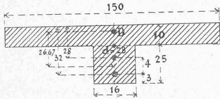
Une poutre de la section ci-dessus et de 3<sup>m</sup>.2 de portée, doit supporter une charge de 1800 kg. par m<sup>2</sup>. Sa section étant de 0<sup>m</sup>.2 environ, son poids propre sera de :  $0,2 \cdot 2500 = 500$  kg. par m. et sa charge totale par m. de :
