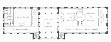
Plan du rez-de-chaussée (Echelle: i cm = 6 m).
