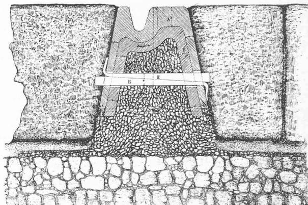
risque de provoquer rapidement la désagrégation du béton. L'expérience ne paraît pas avoir réussi en Angleterre, du moins à Bradford on a constaté l'avantage du rail *Demerbe* de 37 kg. sur béton au rail *Phénix* de 50 kg. dans les mêmes conditions.
