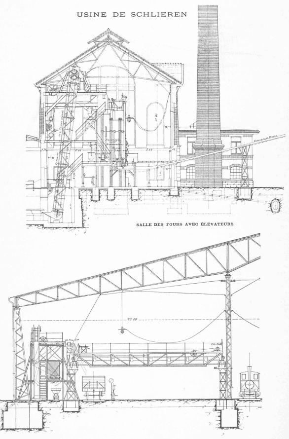
Installation pour la manutention du coke avec transporteur longitudinal et transversal  $\stackrel{\cdot}{\textit{Echelle 1:200}}$
