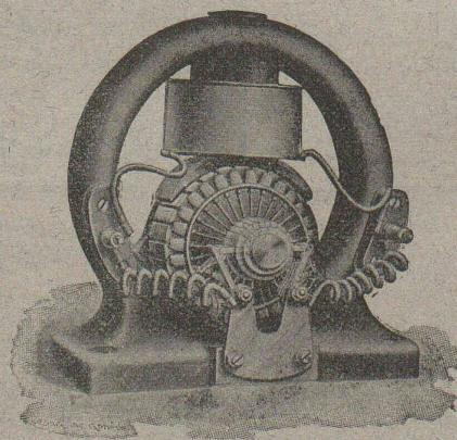
RÉGULATEUR AUTOMATIQUE, syst. R. Thury, nouveau modèle, sans contacts électriques, appliquée au réglage du courant, aux réducteurs d'accumulateurs, etc.
