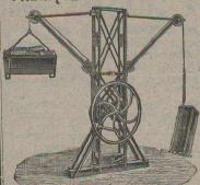
Appareil de levage à double effet
