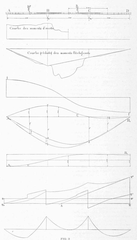
Considérons la poutre en béton de ciment armé, système Hennebique, représentée fig. 2 et soit  $Cc\ D$  la courbe du moment d'inertie correspondante rapportée à l'axe  $A\ B$  (le moment d'inertie de chaque section a été calculé en ne tenant compte que de la section du béton).
