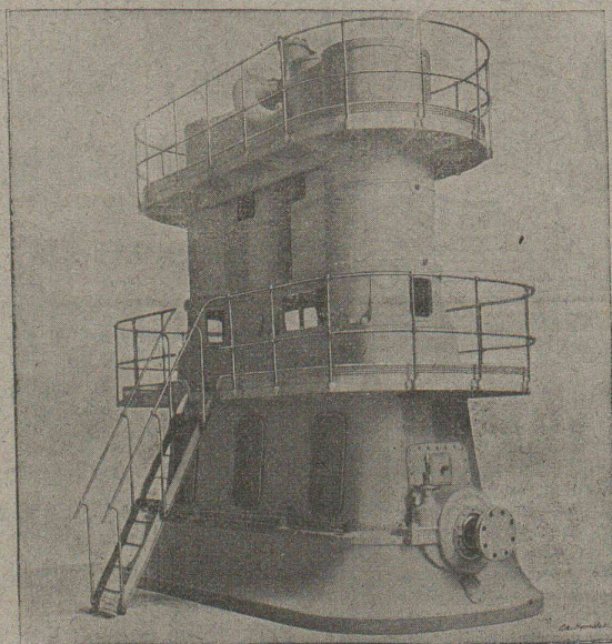
Machine à triple expansion ayant fonctionné à l'Exposition de 1900
