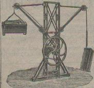
Appareil de levage à double effet
