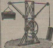
Appareil de levage à double effet
