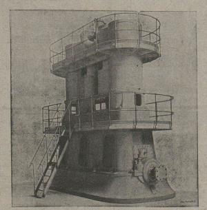
Machine à triple expansion ayant fonctionné à l'Exposition de 1900
