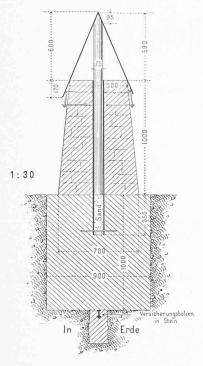
Fig. 2. - Signal trigonométrique
