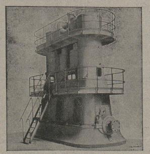
Machine à triple expansion ayant été Installée à l'Exposition de 1900 (Galerie des Groupes électrogènes)
