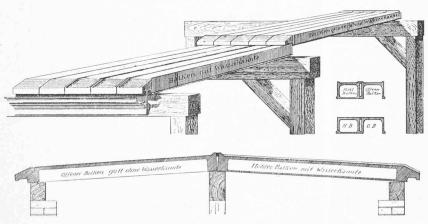
Fig. 8. - CONSTRUCTION D'UNE TOITURE EN TERRASSE
