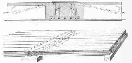
Fig. 5.— Filet noyé dans la construction et subdivisant la portée en travées modérées Echelle du détail 1:10
