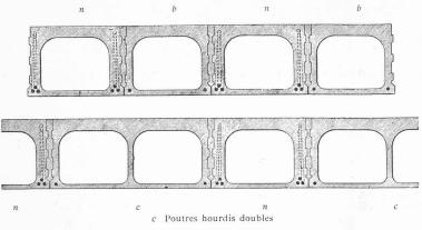
Fig. 2. — Combinaison de poutres normales n avec des poutres plus légères b dites poutres hourdis Echelle 1:10
