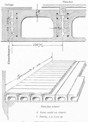
Fig. 1. - PROFIL DES POUTRES
