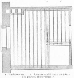
Fig. 3. — POUTRAISON AVEC ENCHEVÊTRURE
