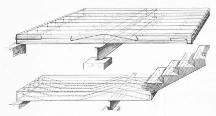
Fig. 7. — Poutraison reposant sur l'aile supérieure ou inférieure de fers laminés de profils divers
