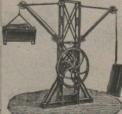
Appareil de levage à double effet
