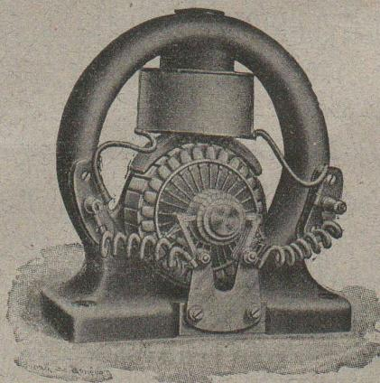
**RÉGULATEUR AUTOMATIQUE**, syst. R. Thury, nouveau modèle, sans contacts électriques, appliquée au réglage du courant, aux réducteurs d'accumulateurs, etc.
