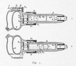
térieure de l'outil contre lequel vient frapper B, E une soupape de distribution dont le siège  $E_1$  est en acier, F la poignée, G  $G_1$  les boîtes dans lesquelles joue la soupape H et I un doigt commandant cette soupape H.
