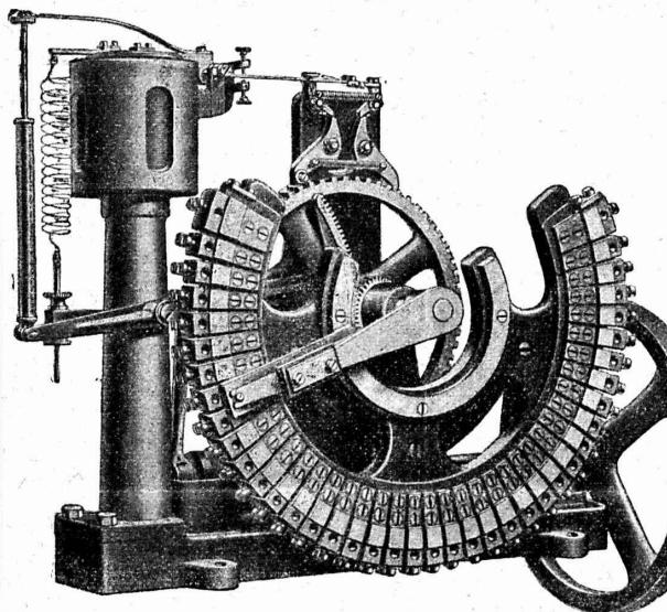
RÉGULATEUR AUTOMATIQUE, syst. R. Thury, nouveau modèle, sans contacts électriques, appliquée au réglage du courant, aux réducteurs d'accumulateurs, etc.
