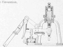
*1* est la tige de la soupape de distribution de construction quelconque qui est normalement fermée par un ressort à boudin 7.
