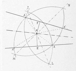
de compas quelconque, et qu'avec cette même ouverture de compas, en prenant comme centre le point d'intersection de l'arc déjà tracé avec l'autre côté de l'angle soit A', on trace l'arc M A' N on obtient un fuseau dont l'axe doit coupera la bissectrice à connaître.
