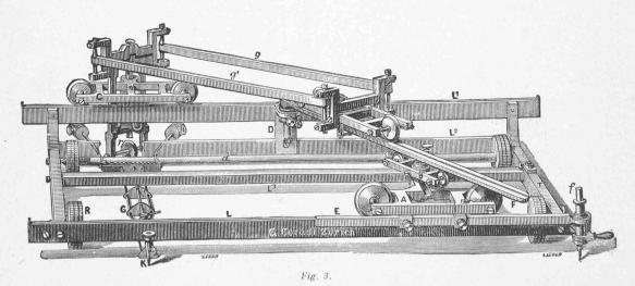
Deux axes d, parallèles aux règles et tournant entre pivots, sont fixés aux traverses; aux extrémités de ces axes se trouvent les 4 cylindres d'égal diamètre R dont le contour est strié.
