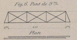
*Diagramme de l'arrangement de poutres avec des panneaux de 6<sup>m</sup> - (Fig. 5 à 10)*
