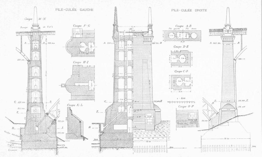
Détails de construction des deux piles-culées.
