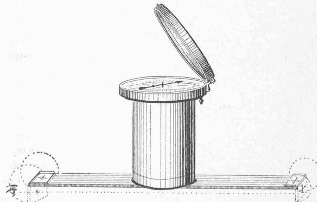
A une réglette métallique bien droite est adapté un cylindre creux dans lequel est suspendue une tige terminée en bas par un poids et en haut par un arc denté; ce pendule actionne par cette crémaillière un petit pignon denté dont l'axe prolongé au dehors du cylindre porte une aiguille plus grande qui vient reproduire, en les amplifiant sur un cadran divisé, les mouvements décrits par le pendule dont nous venons de parler.
