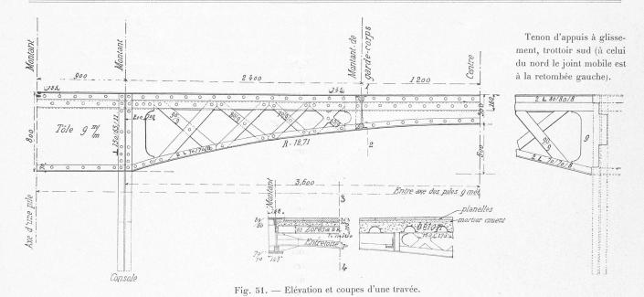
carré de trottoir, donne 400 kg. sur o<sup>m</sup>80 de largeur. La poutre portant donc au total 820 kg. par mètre, et sa portée étant 7<sup>m</sup>20, le moment d'encastrement a pour valeur
