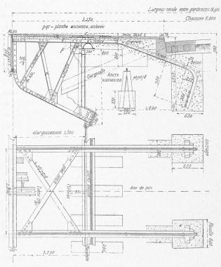
Fig. 49 et 50. — Coupe contre une console et plan d'une paire de console.
