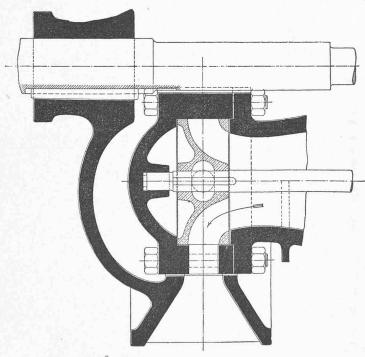
La vitesse pour 240 tours est de  $22^m5$  au diamètre moyen, soit  $^4/_4$  de la vitesse critique et la tension de travail de  $^4/_{46}$  de la résistance absolue à la rupture par l'effet de la force centrifuge.
