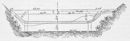
Fig. 5. — Elévation du contrebarrage dégagé des terres.
