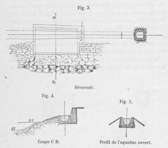
A l'aval de ce déversoir, une vanne permet de régler la quantité d'eau qui doit entrer dans le canal proprement dit d'amenée de l'eau motrice.
