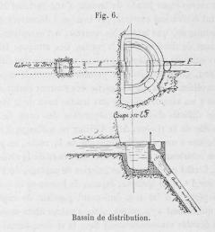
La conduite métallique entre le bassin et le bâtiment des turbines est en tôle, elle a 1<sup>m</sup>20 de diamètre et sa longueur est de 100 m.; elle débitera facilement la moitié de l'eau disponible. Lorsqu'il s'agira d'utiliser la seconde moitié, il faudra poser une seconde conduite.
