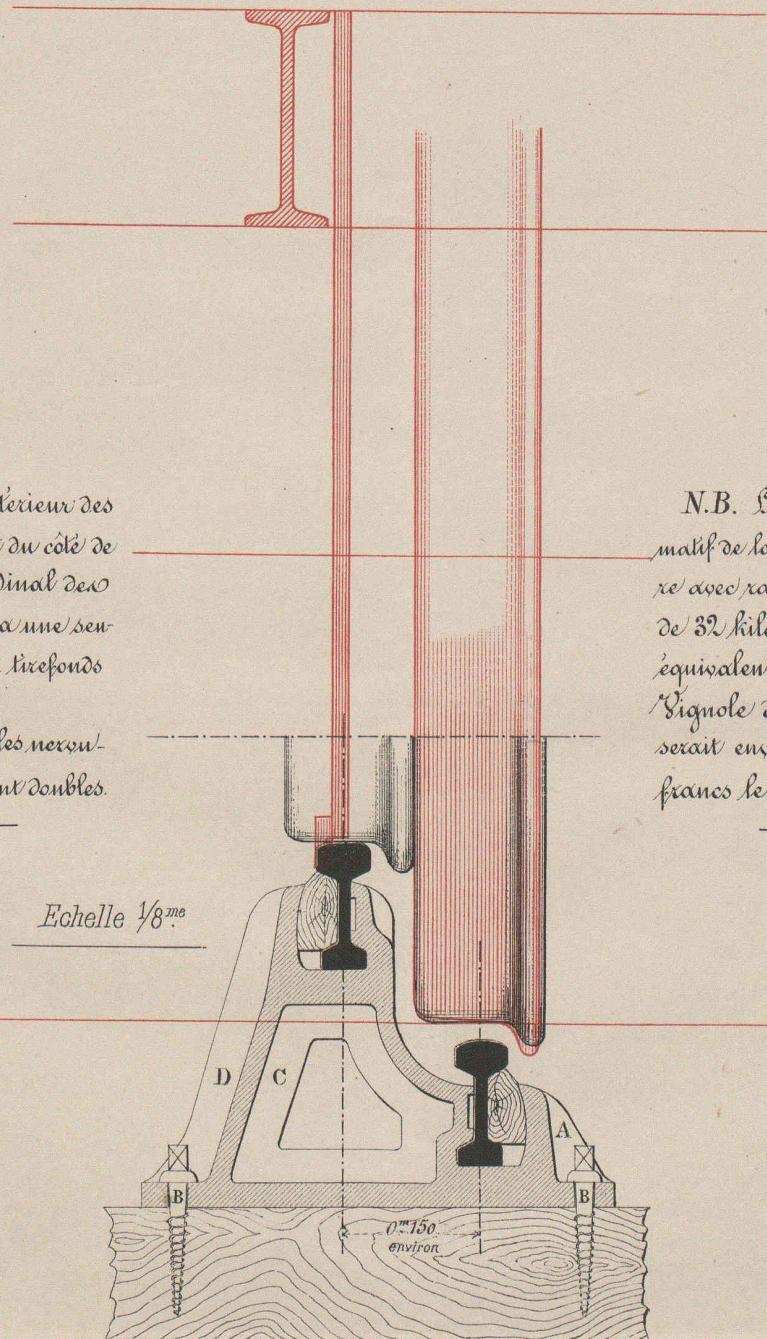
N.B. À l'intérieur des coussinets, soit du côté de l'axe longitudinal des voies, il y aura une seule nervure et 2 tirefonds B.
