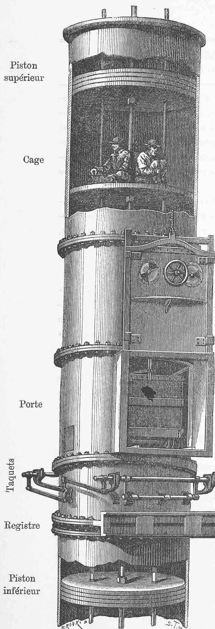
Il vient d'être établi récemment dans les mines de houille d'Épinac (Saône-et-Loire) un nouveau puits dont la profondeur dépasse aujourd'hui 600 mètres et sera poussée plus tard jusqu'à 800 et même jusqu'à 1000 mètres au-dessous de la surface du sol. Ce puits ouvre à l'exploitation des gisements houillers dont la richesse est évaluée à 400 millions d'hectolitres sur un champ de 400 hectares.
