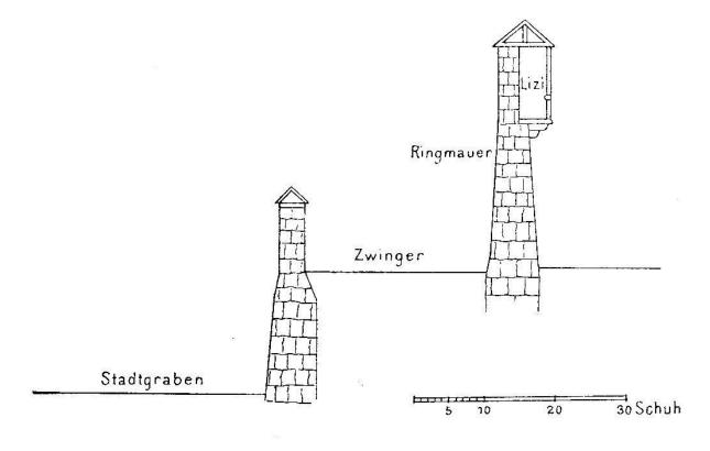
daß die Lizi beschädigt würde. In einem Plane zu diesem Projekt sind auch die beiden Ringmauern mit der Lizi angegeben. Wir entnehmen diesem Plane folgende Maße: Die Höhe der innern Ringmauer beträgt 30 Bern Schuhe, ihre Dicke 5—6'. In einer Höhe von 19' ist die Lizi (der Wehrgang) angebracht. Der Zwinger hat eine Breite von 24'; die Maße der äußern Kingmauer sind: Breite 3', Höhe  $8^{1/2}$ ', der Stadtgraben ist  $13^{1/2}$ ' tief und 65—70' breit.
