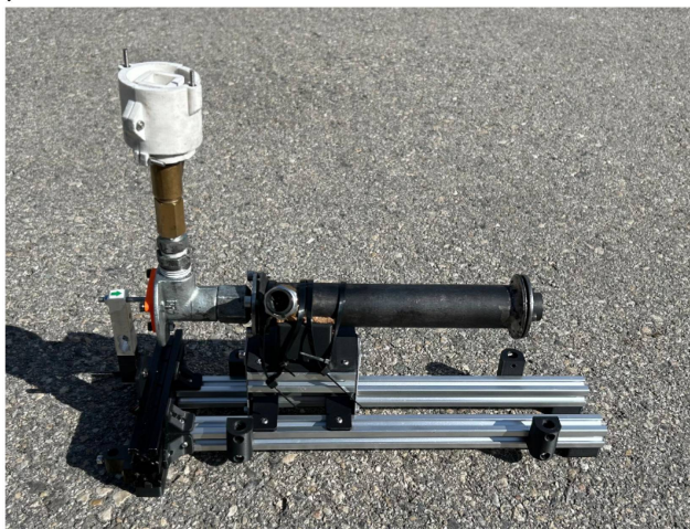
Figure 8. Photographie du moteur fixé sur le banc de test final: De gauche à droite: capteur de poussée, vanne d'injection d'oxydant (entourée d'un support imprimé en 3D), support de maintien du moteur, chambre de combustion (tube en acier) et tuyère en graphite visible à l'extrémité droite. Cela démontre qu'une propulsion hybride est accessible à l'échelle expérimentale dans un cadre scolaire.
