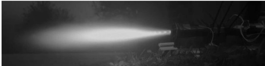
Figure 7.: Photographie de la flamme du moteur montrant des disques de Mach (shock diamonds):
