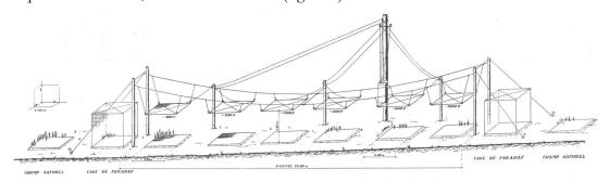
**Figure 1.** Installation pour l'étude du champ électrique terrestre. Les grilles différemment chargées sont suspendues à deux câbles porteurs. Le mât principal porte le poste redresseur pour tensions continues.
